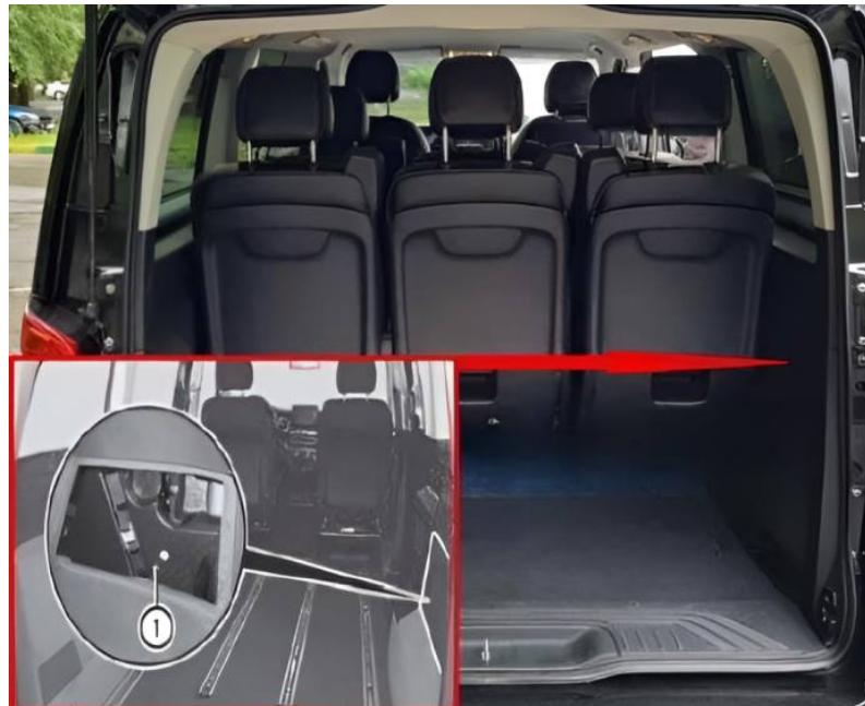
La boîte à fusibles se trouve sur le côté droit du compartiment à bagages, derrière le couvercle de protection.
