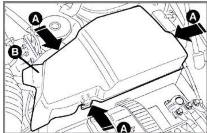
La boîte à fusibles sous le capot se trouve à proximité de la batterie. Pour y accéder, il faut d'abord appuyer sur les trois supports (A) et retirer le couvercle de protection (B). Près de la borne positive de la batterie se trouve un panneau de fusibles à courant fort.
