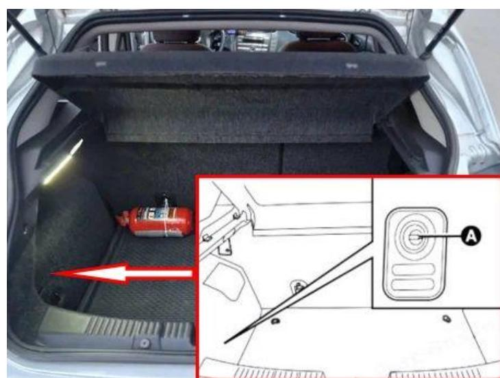
Se trouve sur le côté gauche du coffre à bagages. Pour accéder aux fusibles, il faut appuyer sur les supports (A) et retirer le couvercle de protection (B).
