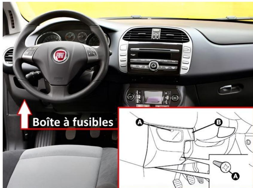
La boîte à fusibles se trouve derrière un revêtement de protection en bas du tableau de bord. Pour accéder aux fusibles, il faut dévisser les trois vis (A) et retirer le cache de protection (B).
