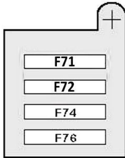
F71. | Protection des circuits électriques de la boîte à fusibles de l'habitacle | 70A
