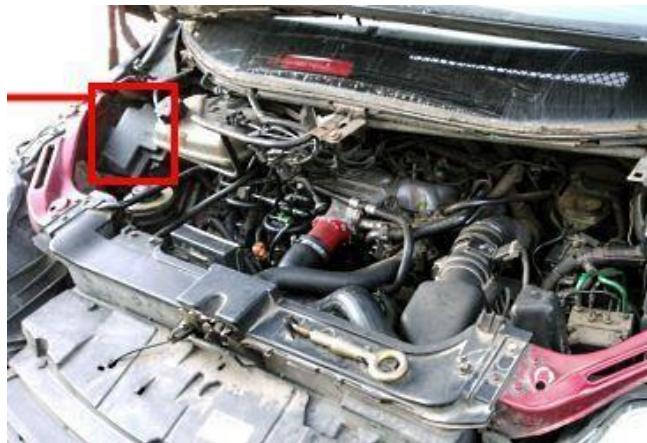
Il se trouve à proximité du réservoir de détergent. Le réservoir doit être retiré pour y accéder.
