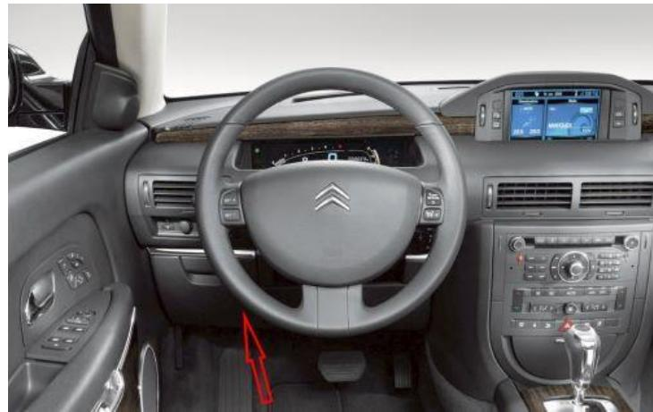
La boîte à fusibles se trouve du côté conducteur (conduite à gauche) ou derrière la boîte à gants (conduite à droite).
