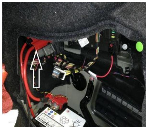
Le tableau électrique se trouve sur le côté droit, derrière le carénage, à proximité de la batterie.
