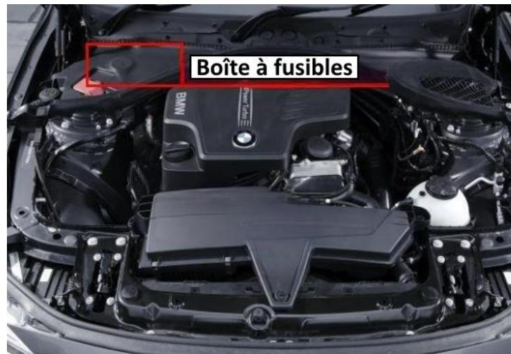
Le bloc principal se trouve sur le côté droit, plus près du pare-brise. Pour y accéder, il faut dévisser les vis de fixation du revêtement de protection. À côté de lui se trouvent quelques modules de relais et des fusibles de puissance.
