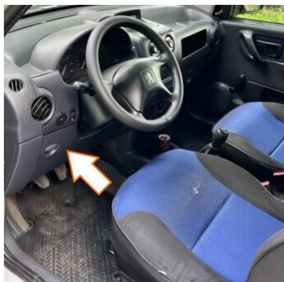
La boîte à fusibles se trouve côté conducteur, sous le tableau de bord. Pour y accéder, il faut retirer le cache de protection.
