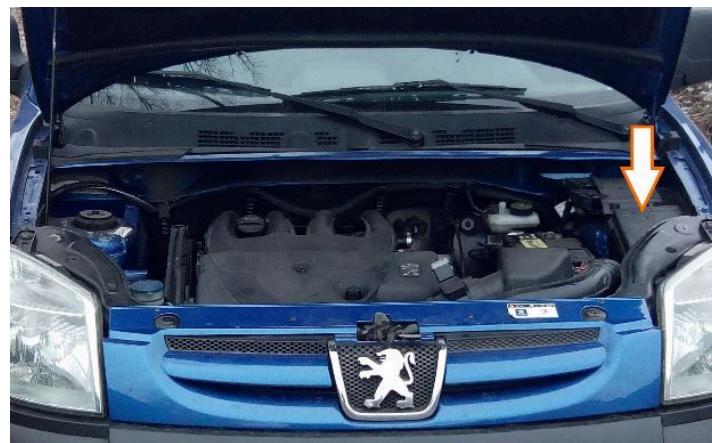
Le boîtier à fusibles se trouve derrière le capot de protection, près de la batterie.
