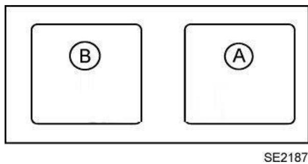
Des modules de relais de chauffage supplémentaires se trouvent sur l'unité de chauffage de la console centrale : a - 40A (1067) ; b - 70A (1068).
