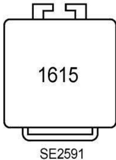
Module de relais séparé « + » lorsque le moteur tourne - situé sous le siège du passager.
