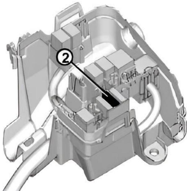
Il existe également un fusible spécial pour interrompre le fonctionnement de l'installation de bouteilles de gaz.
